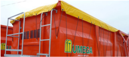
Krycí plachta s plošinou
